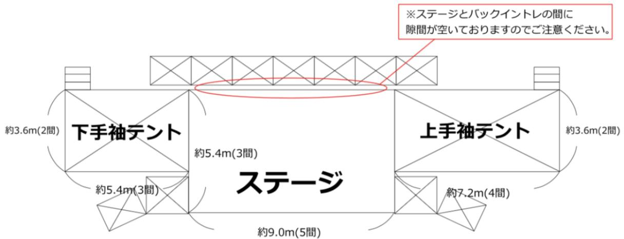
また、下図はおまつり広場ステージ企画に関連する部分の大まかな配置です。ステージは吉田南グラウンドの北西に設置され、ステージの南東（正面）にはピンスポットタワーとPAテント、北西（背後）には控えテントが設置されます。控えテントは3.6 m×7.2 mのテント2つと3.6 m×5.4 mのテント2つです。
